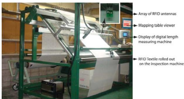
図4 開発したマッピング装置
