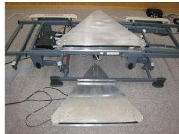
図2. 実験に用いた床反力計
