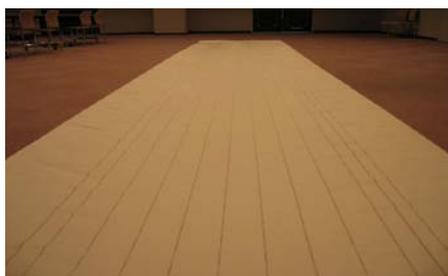
図 3 試作した RFID テキスタイル
